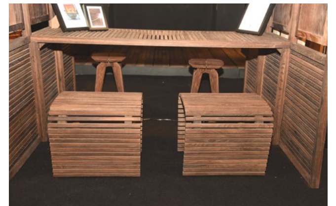
Gỗ sồi đỏ biến đổi nhiệt sau 5 tháng thử nghiệm mùa mưa ở Java tại Indonesia
